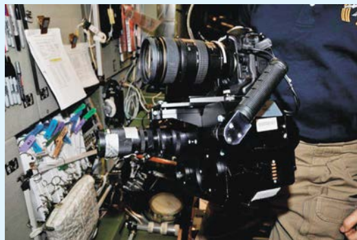
Аппаратура фотоспектрометрической системы на борту РС МКС.
