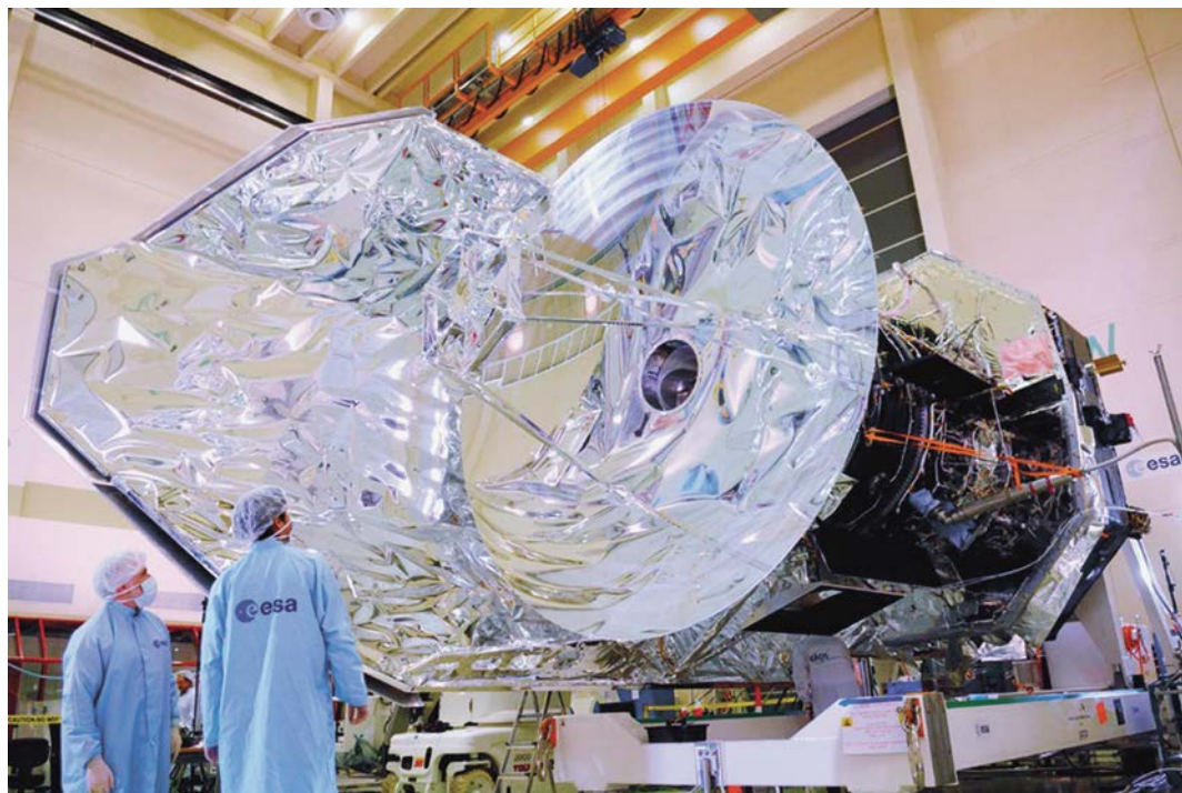
Зеркало телескопа диаметром 3,5 м изготовлено французской фирмой EADS-Astrum (Тулуза), оно установлено на космической обсерватории “Гершель” во время сборки в Нидерландах. 2007 г. Фото ESA.
