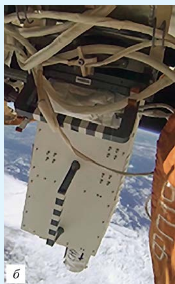
Камеры высокого (а) и среднего разрешения (б) для проведения эксперимента "Напор-мини РСА", установлены на внешней поверхности служебного модуля "Звезда" РС МКС.
